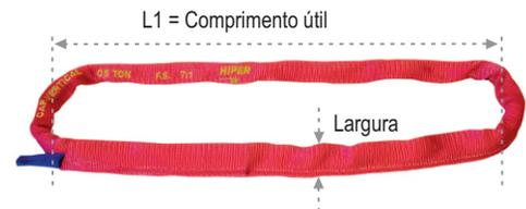
Cintas redondas com capa extra reforçada e costura lateral | Conforme NORMA Brasileira NBR 15637-1. | Fabricadas 100% em poliéster de alta tenacidade.
